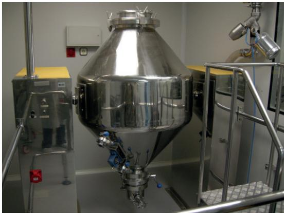
Mélangeur biconique avec système de chargement et de déchargement automatique
